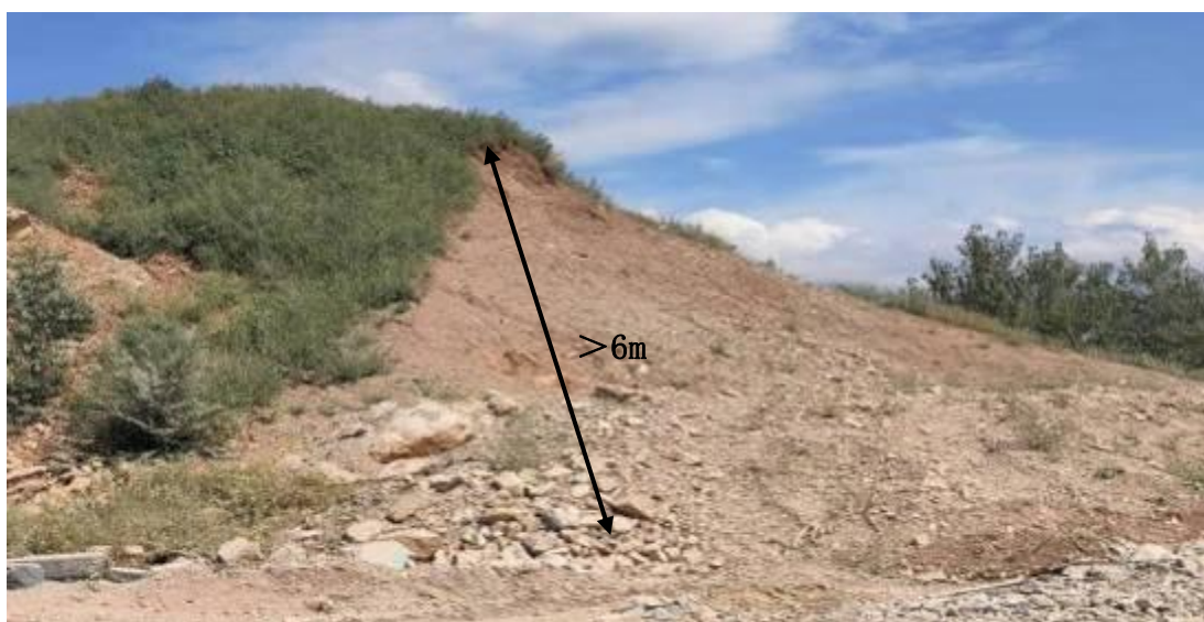
图 2-3 二采区坡积土剖面示意图
